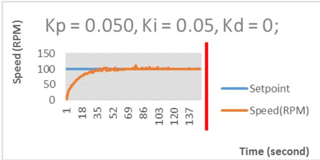
Fig. 14. PID Tuning  $K_p=0.050$  ,  $K_i=0.05$  ,  $K_d=0$
