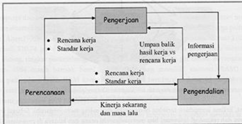
Gambar 1.8 Hubungan perencanaan, pengerjaan, dan pengendalian dalam sebuah subsistem
