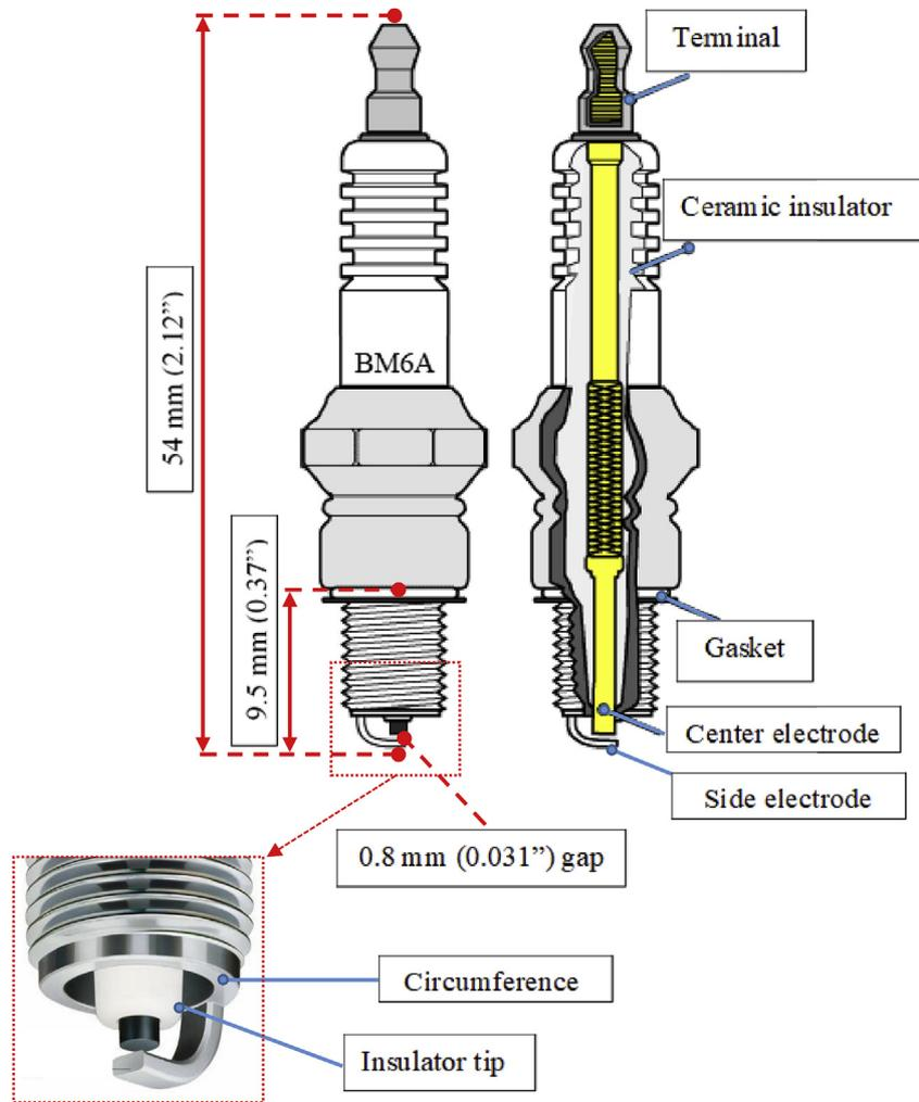
Fig. 2. NGK BM6A spark plug.
