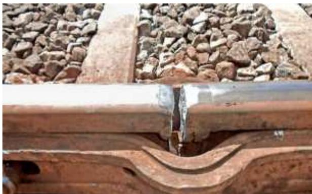
Fig. 2. Crack
