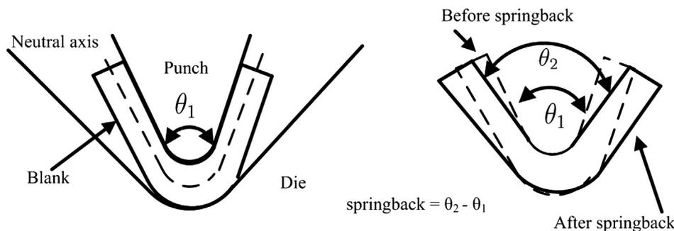
Fig. 5. V-bending test schematic [24].
