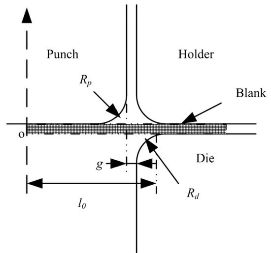
Fig. 6. L-bending test initial setup [16].
