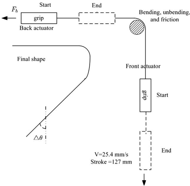
Fig. 9. Schematic of Draw-bend test [10].
