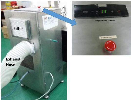
Fig. 8 Actual cooling tunnel
