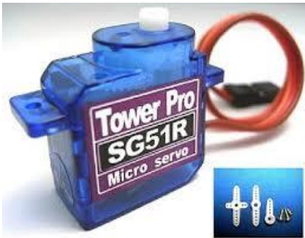
Fig. 1. SG51R Micro servo
