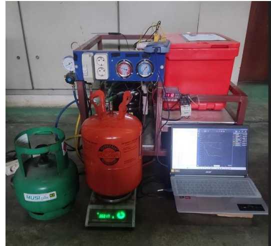
Gambar 2. Foto freezer tempat uji retrofit refrigeran R404A dengan R290.
